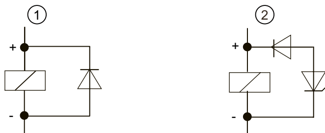
Figura 3-2 Proteger bobinas alimentadas por corriente continua
