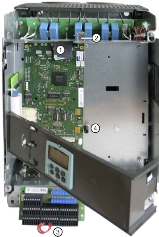
Figura 11-11 Sustitución de CUD 1
