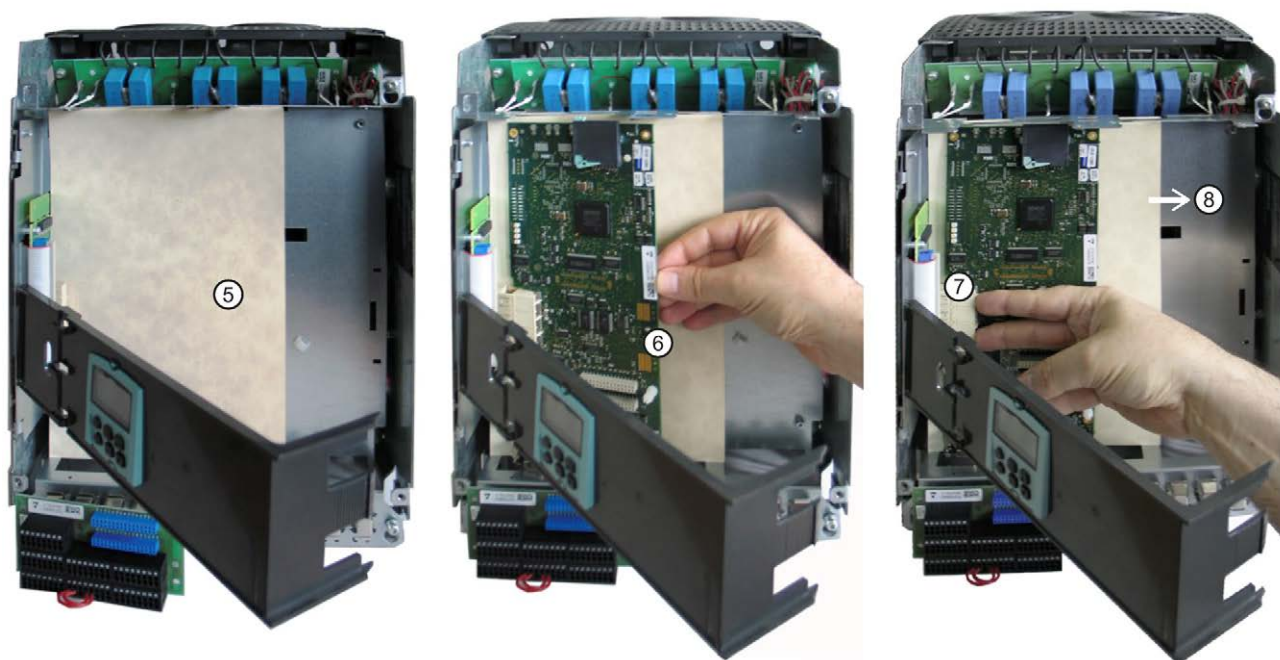
Figura 11-12 Sustitución de CUD 2
